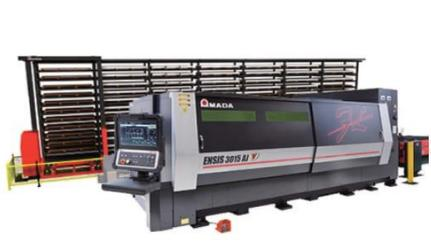
最新鋭のファイバーレーザー加工機と材料自動供給棚
