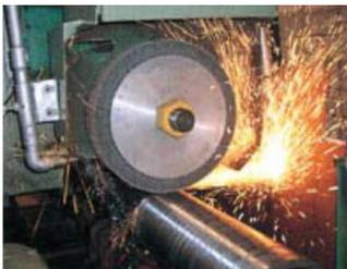
円筒物ではφ50～200mm、板研磨では30～150mm幅×1.5mの研磨物のテストが可能な大型研磨機を完備
