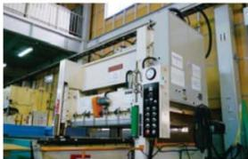
大型打抜き加工に対応するプレス機
