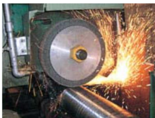
円筒物ではφ50～200mm、板研磨では30～150mm幅×1.5mの研磨物のテストが可能で大型研磨機を完備
