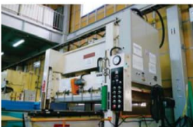
大型打抜き加工に対応するプレス機
