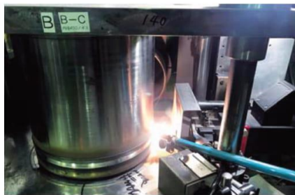
ファイバーレーザー溶接作業
